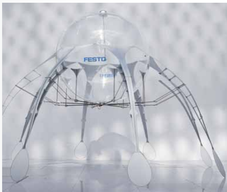
Festo AirJelly – lebegő medúzarobot, ami az egyedülálló perisztaltikus FinRay Effect® segítségével mozog a levegőben (a Festo Bionic Learning Network fejlesztése)
